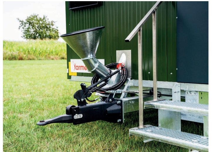
STARTER-plus & STARTER-max : Trémie de remplissage et timon à freinage par inertie
